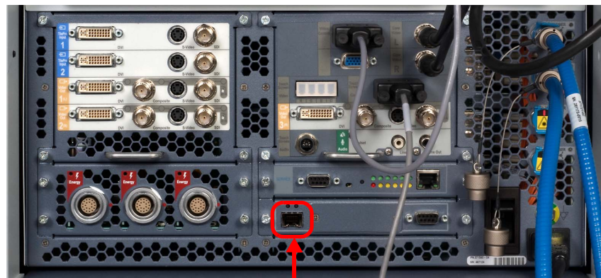
Figure 6 RJ-45 Connector – Core (da Vinci Si)
